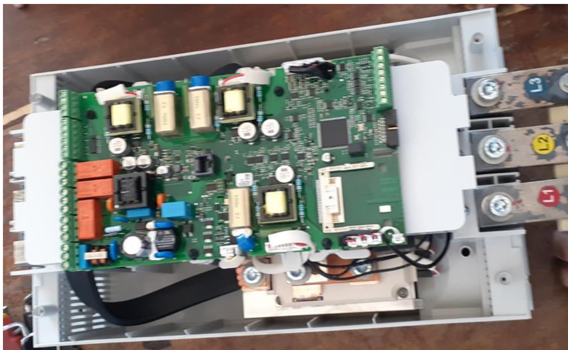
الشكل 2 : شكل عملي لدائرة التحكم (كارت PCB) الخاص بوحدة soft starter من الداخل
