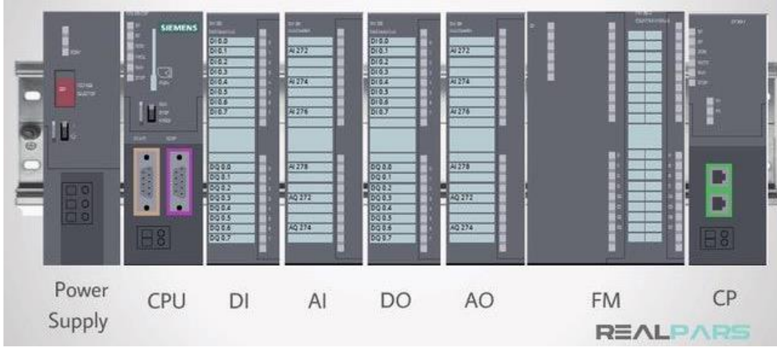
الشكل 6 : وحدة التحكم Siemens PLC
